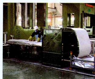
② Raw material sheet cutting 原料切割
