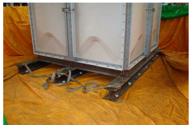
圖 2：測試件基座安裝於 3 支平行的 H 型鋼，而 H 型鋼再以 M30 的螺栓固定於振動台上。
